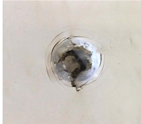
Figura 6 – Foto de um corpo de prova da amostra “Revestimento poliéster flexível - Sistema Fibersals” após impacto a 50°C
