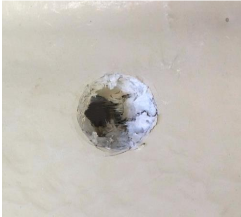
Figura 5 – Foto de um corpo de prova da amostra “Revestimento poliéster flexível - Sistema Fibersals” após impacto a 23°C
